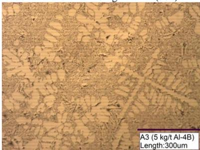
Figura 13 – Microestrutura Teste A3 – 5 kg/t Al-4B (50x)
