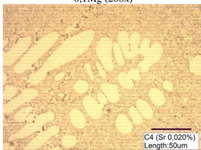
Figura 23 – Teste C4 – 60 min – Microestrutura modificada da liga Al-11Si-0,1Mg (200x)
