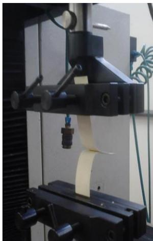
Figura 4 - Ensaio de tração em corpos de prova de papel.
