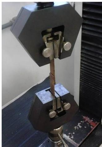
Figura 3 - Ensaio de tração em corpos de prova de madeira.
