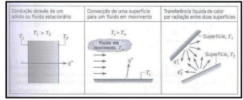
Figura 2- Modos de transferência de calor. Fonte: Incropera & Dewitt [3].
