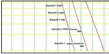
Figura 19: Segmentos de reta de Biots<sup>-1</sup> em cores alternadas azuis e vermelhas representam as equações distintas existentes em toda a carta. Fonte. Autor
