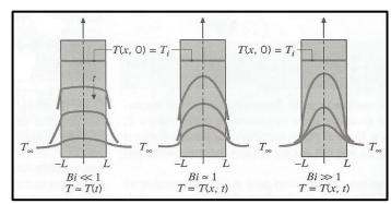
Figura 4: Biot e perfis de temperatura. Fonte: Incropera & Dewitt [3].
