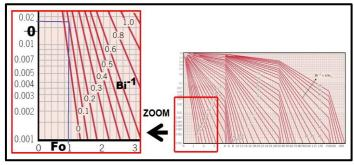
Figura 6: Possíveis erros durante a interpolação manual. Fonte: Adaptado Bergman et al. [7]
