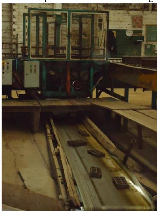
Os tijolos que apresentarem qualquer tipo de dano são descartados nesta etapa. A vantagem em descartá-los anteriormente à queima propriamente dita é a possibilidade de reintroduzi-los no processo, uma vez que podem ser extrusados novamente. Na Figura 4 podem ser visualizados os resíduos do processo de secagem.
