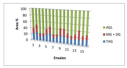
Figura 9 - Conversões dos Triacilgliceróis em Mono, Di e Ácidos graxos livres do óleo de Canola.
