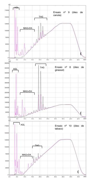
**Figura 7 -** Cromatogramas obtidos por HPLC dos produtos de glicerólise dos óleos de canola (A), girassol (B) e tabaco (C).
