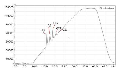
Figura 4 - Cromatograma obtido por HPLC do óleo de tabaco.
