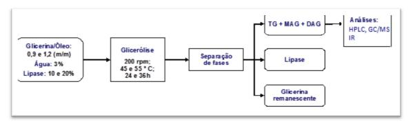
Figura 1 - Fluxograma com as etapas da reação de glicerólise enzimática.
