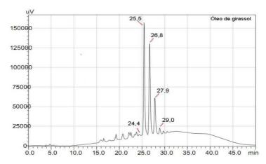
Figura 3 - Cromatograma obtido por HPLC de óleo girassol.
