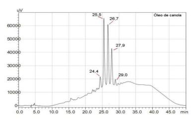
Figura 2 - Cromatograma obtido por HPLC do óleo de canola.
