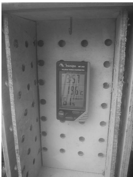
**Figura 5:** Mini-abrigo meteorológico com termo-higrômetro digital.
